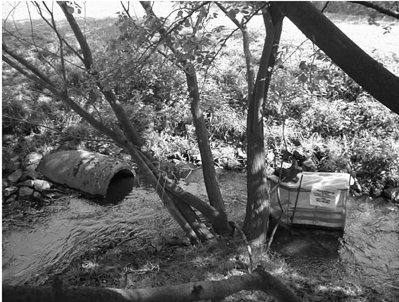
Abb. 2: Experimentalbehälter 2 m unterhalb einer Abwassereinleitung
