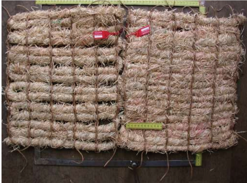
Abb. 1: Problemuster der textilen Vegetationsträger aus Holzwolle (Grundfadensystem Papier- und Hanffaden). Links die gitterartige, rechts die lichtdichte Variante.
