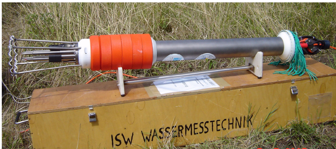
Abbildung 1: Mikrostruktursonde MSS90. Mit den roten Auftriebsselementen ist die Sonde für eine Steiggeschwindigkeit von ca. 0,6 m/s ausbalanciert.
