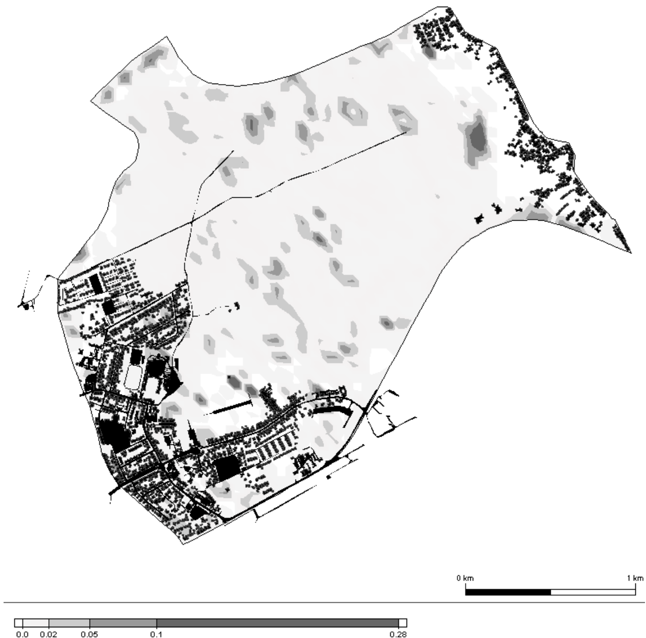
Abb. 2: Akkumulierte Sedimentmächtigkeit [m] 10 Stunden nach Dambruch.
