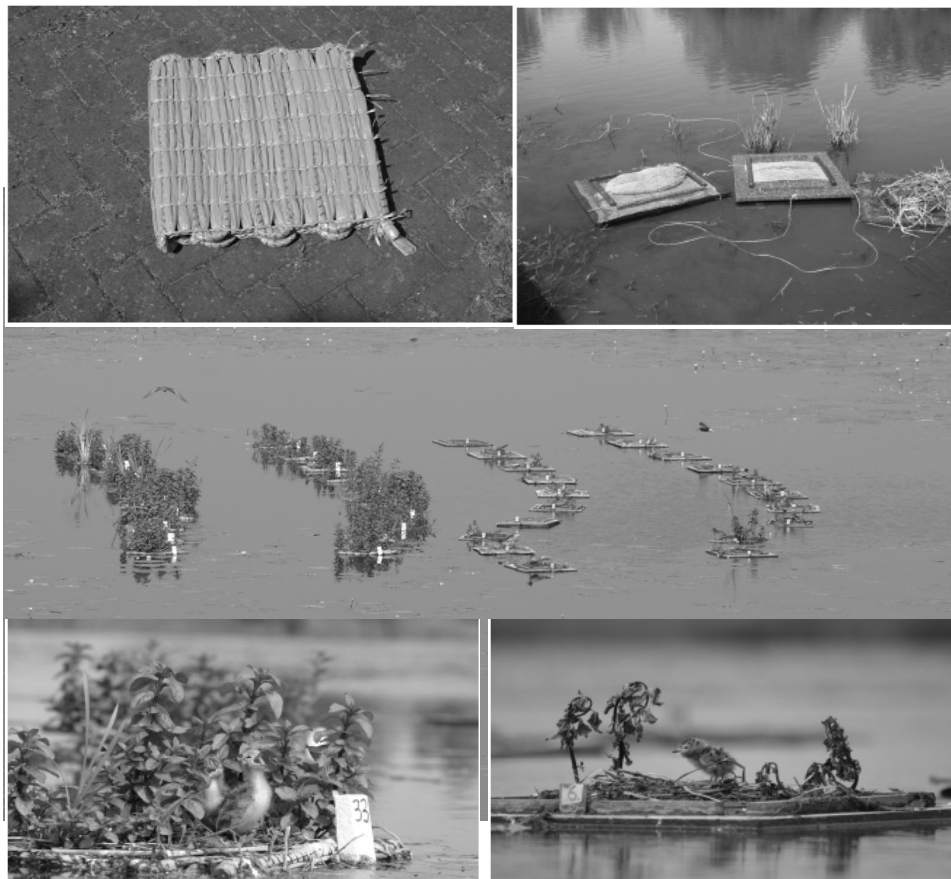
Abb. 3: linke Seite: textile schwimmende Inseln; rechte Seite konventionelle Kunststoff-Flöße (Fotos Achim Vossmeier)
