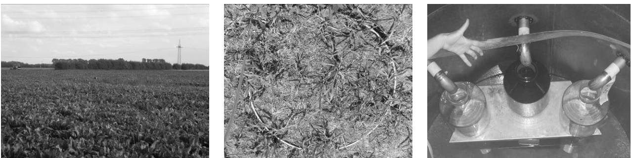
Abb. 2: Versuchsfeld mit Verregnungsmaschine (links), im Boden eingelassenen Lysimeter (mitte), Auffangbehälter aus Glas nach 40, 80 und 120 cm Bodenpassage (rechts).
