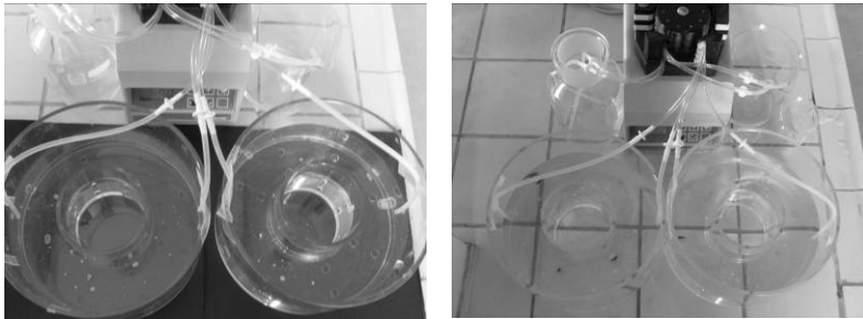
Abb. 3: Driftmesser mit G. pulex (weißer Untergrund) und N. schellenbergi (schwarzer Untergrund), links befindet sich die Versuchsgruppe, rechts die Kontrollgruppe.
