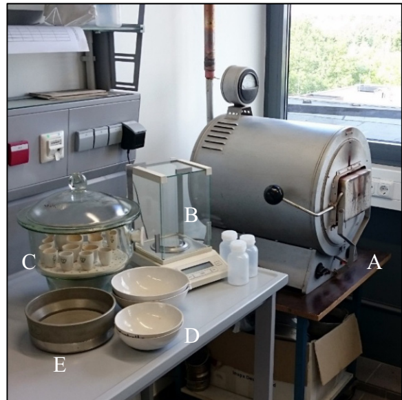
Abbildung 3: Ausstattung für die Laborarbeit A: Muffelofen B: Feinwaage C: Exsikkator mit Keramiktiegeln D: Keramikschalen E: 63 µm-Sieb
