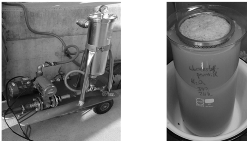
Abbildung 1: Anreicherungstechnik (links) und chemische Behandlung der gewonnenen Probe im Siebkorb (rechts)
