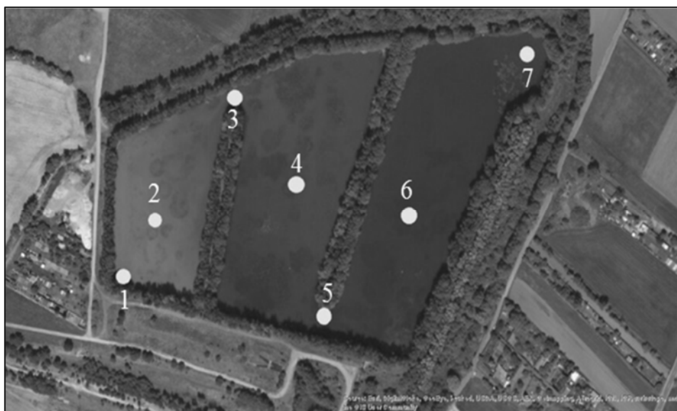
Abb. 2: Sedimentationsbecken am Vetschauer Mühlenfließ mit Beprobungsstellen vom Zulauf (1) bis zum Ablauf (7)
