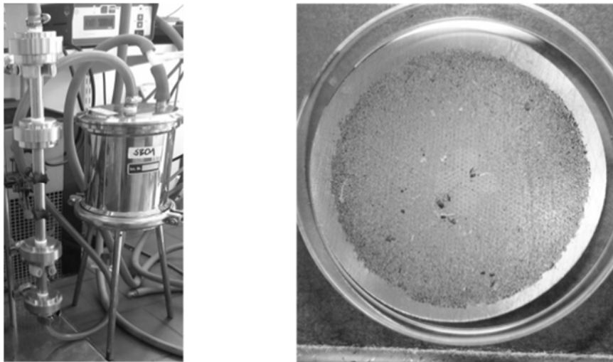
Abbildung 2: Probenfraktionierung über eine Siebkaskade (links) und Probe anschließend auf einer Siebrönde (rechts)
