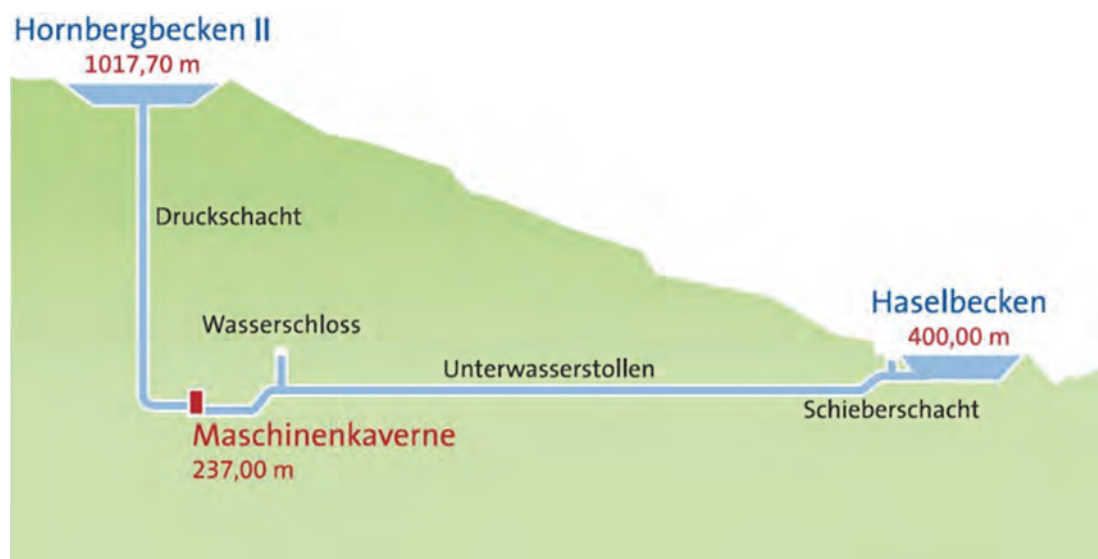
Abb. 1: Funktionsschema des PSW Atdorf mit Oberbecken, Unterbecken und Verbindungsstollen
