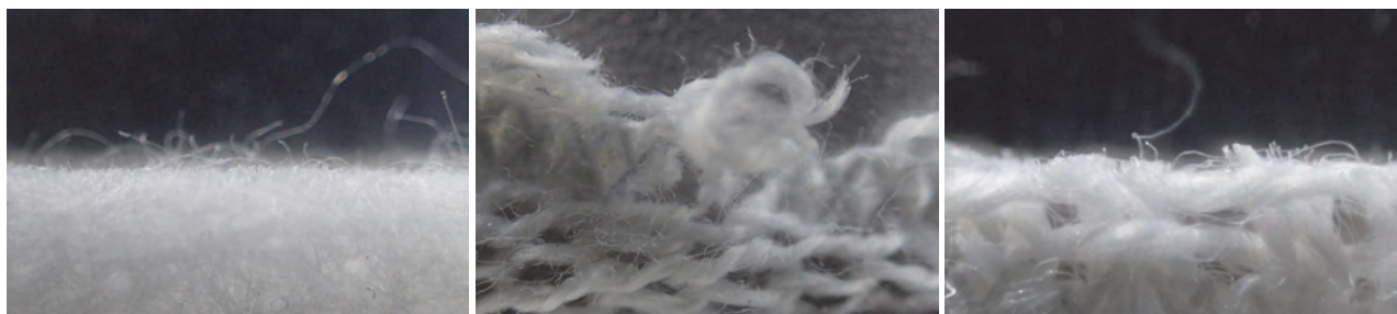
Abbildung 11. (l) Vliesstoff NFV2, (m) Gestrick FLS8 (r) Gewebe RIG7 5-fache Vergrößerung der Schnittkante
