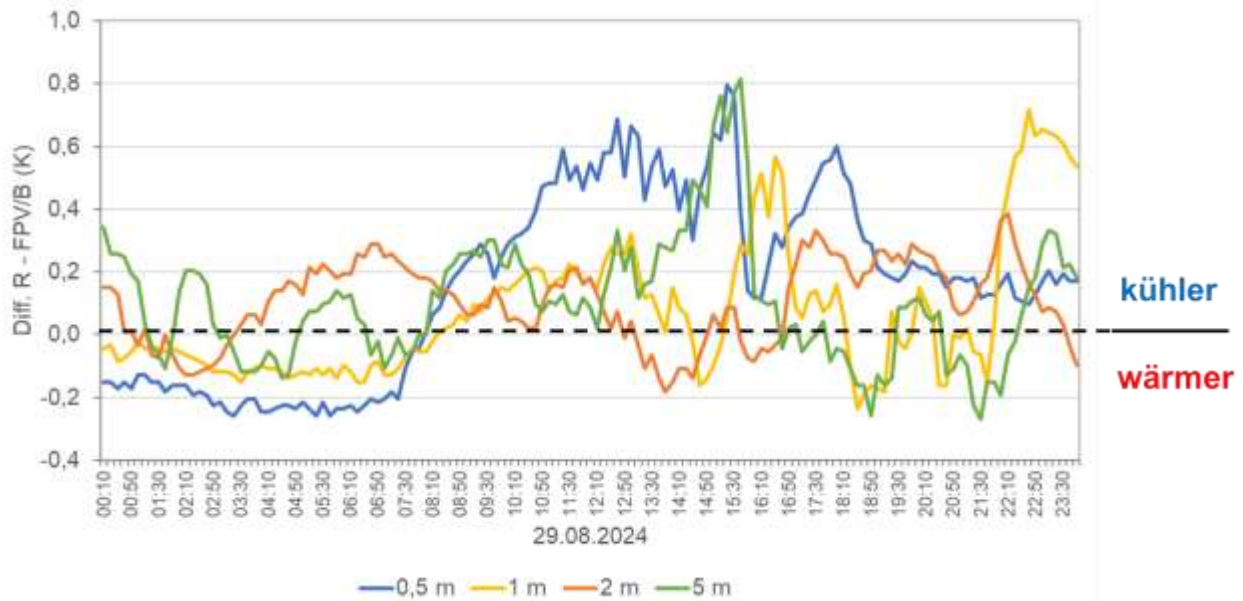
Abb. 3: Differenz der Wassertemperatur zwischen der Referenzstelle (R) und unter der Anlage B in verschiedenen Tiefen im Tagesgang an einem Tag mit hohen Lufttemperaturen (Tagesmittelwert der Lufttemperatur: +25,9°C, Summe der Sonnenscheindauer: 12,3 h).
