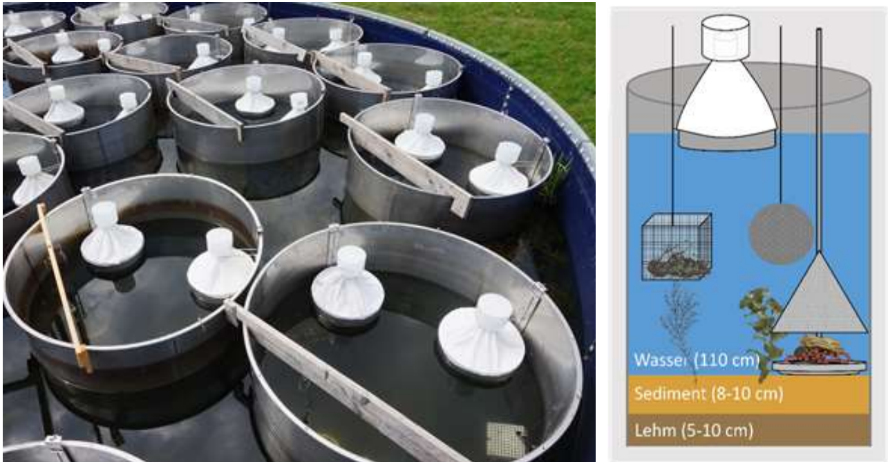
Abb. 1: Aufbau der Mesokosmenanlage mit abgetrennten Becken von je 1000 L Fassungsvermögen (links) und Querschnitt durch ein Mesokosmenbecken mit Fangvorrichtungen (rechts).
