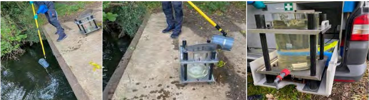
**Abb. 1: Probenahme an einem Fließgewässer mittels Teleskopstange mit Schöpfbecher (links), Umfüllen der Teilprobe in ein Homogenisiergefäß (Mitte) und homogenisierte Stichprobe (rechts) (Quelle: LANUV NRW).**
