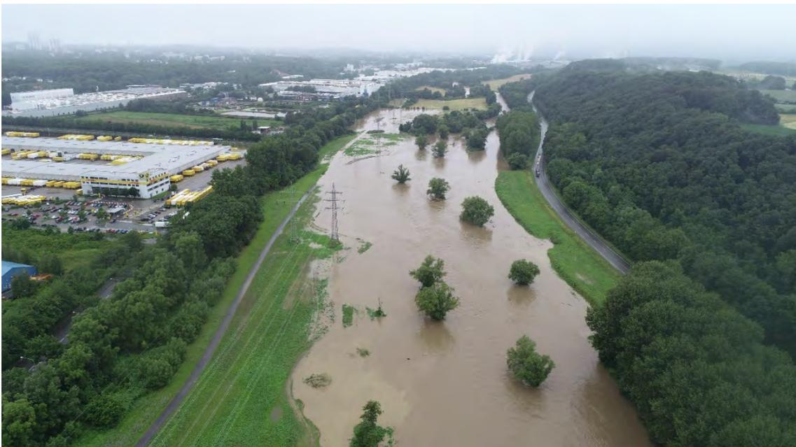
**Abb. 9: Lenne 1.BA, das Retentionsvolumen von rund 60.000 m<sup>3</sup> wird nach dem Extrem-Hochwasser und Starkregen im Raum Hagen vollständig aktiviert, 14.07.2021, Foto: Biologische Station Umweltzentrum Hagen.**
