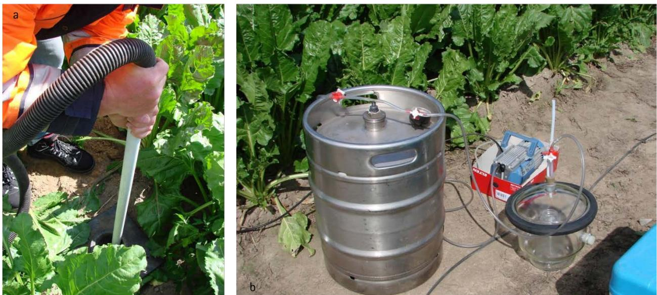
**Abb. 3: BGR-Staubsaugermethode: a) Absaugung des Bodenmaterials, b) Anlegen eines Vakuums mittels Saugpumpe und Ausgleichsbehälter, Auffangen der Wasserprobe im Exsikkator**
