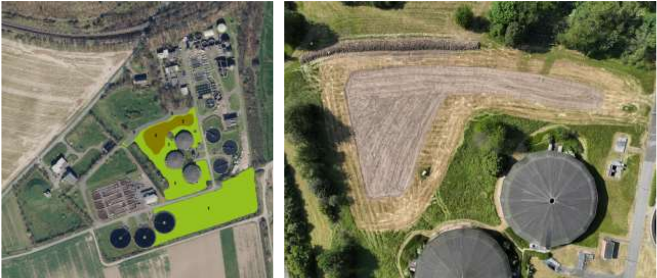
Abb. 4: Kläranlage Moers-Gerdt (links: Übersicht mit Planvorgabe der Maßnahme, 1 – Mahd mit Balkenmähwerk und Entnahme des Mahdguts, 2 – Abschiebung der obersten Bodenschicht und Einsaat einer regional- und biotoptypischen Auswahl von Pflanzenarten, 3 – Anlagerung der abgeschobenen Bodenschicht als flache, verdichtete Anschüttung; rechts: präparierte Fläche mit abgeschobenem Boden und Malaise-Falle).
